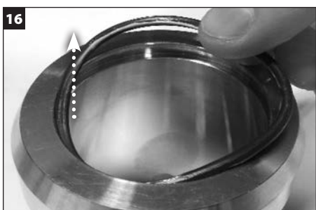
16 Remova e descarte o O-ring (V) do eixo da luva.
