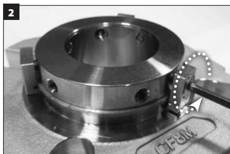
Remova e descarte os grampos de centragem.
