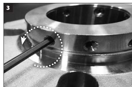
Remova e descarte todos os parafusos sextavados internos de ponta cônica e parafusos sextavados internos sem cabeça 1/4 do anel de trava.
