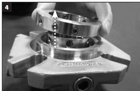
Remova o anel de trava da luva e deixe de lado.
